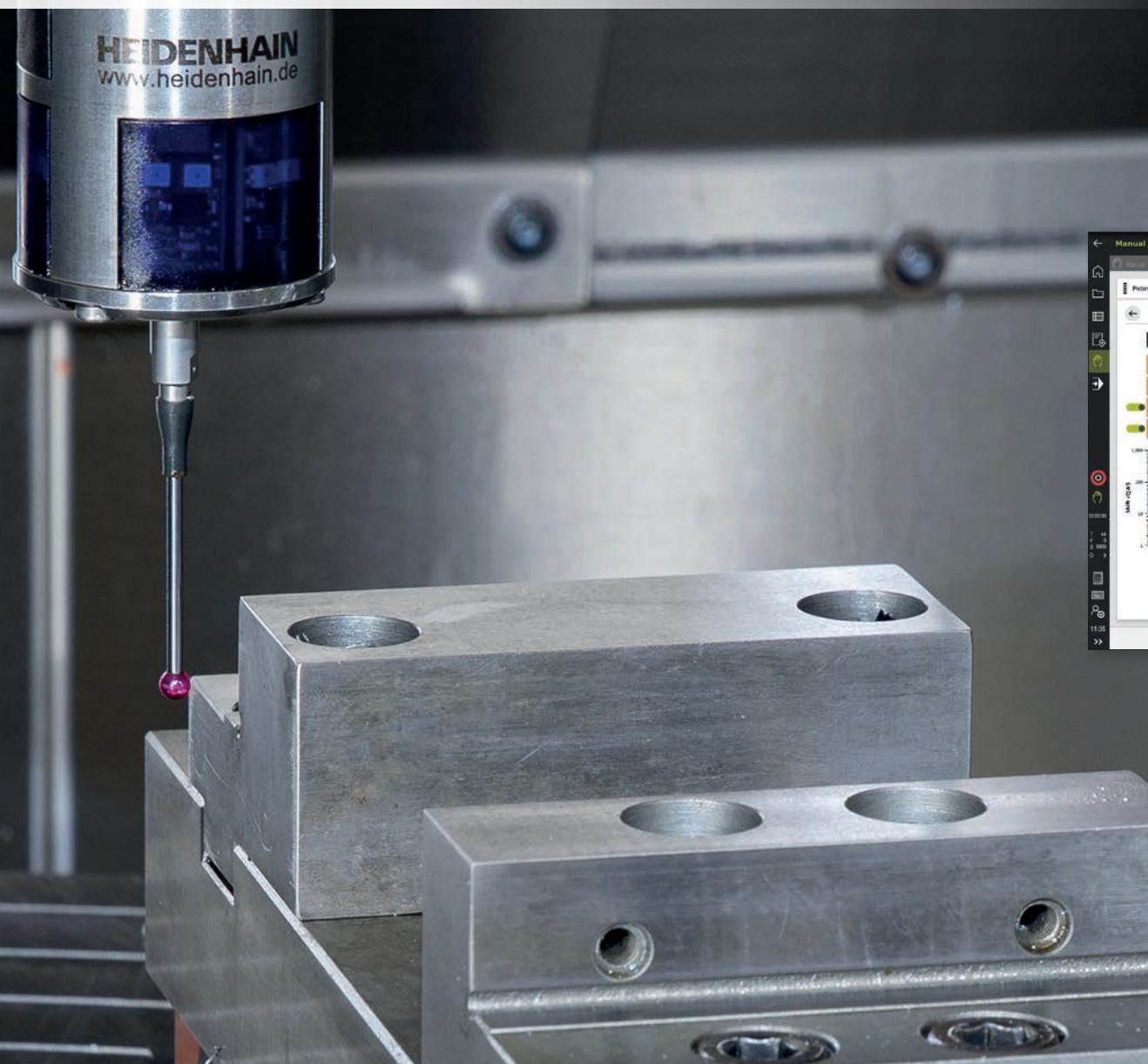
TNC7 nabízí kompletní ochranu stroje díky funkci DMC nové generace. DCM chrání nejen před kolizemi mezi díly stroje a nástroji. Také upínací prostředky lze importovat ve 3D formátech, monitorovat a díky novému cyklu s grafickou podporou jednoduše proměnovat.
