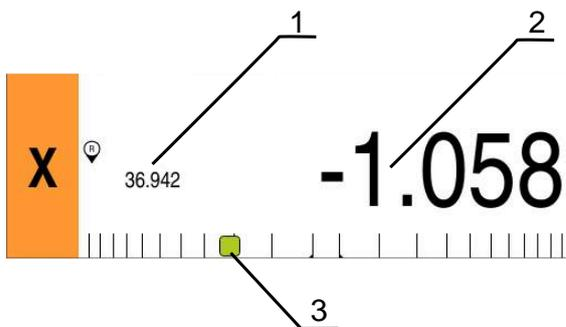
圖形 42: 位置的剩餘距離 畫面含圖形定位輔助
