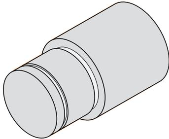
圖形 34: 範例工件空間-車削凹槽
