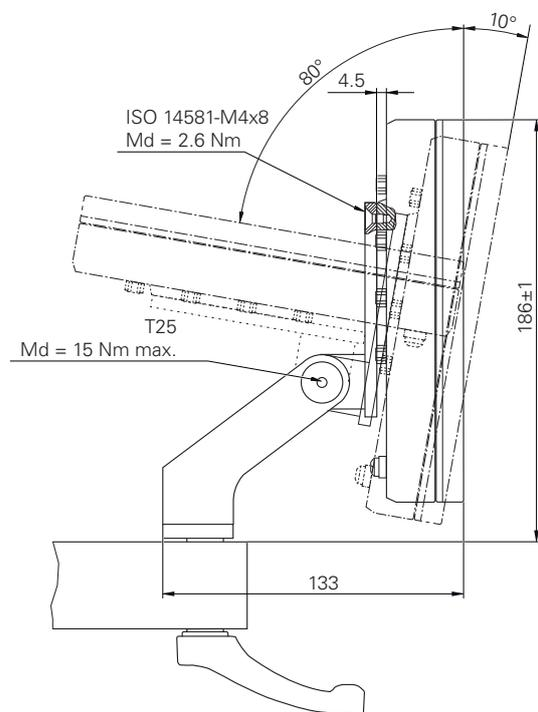
圖形 60: 含多位置固定架的產品尺寸
